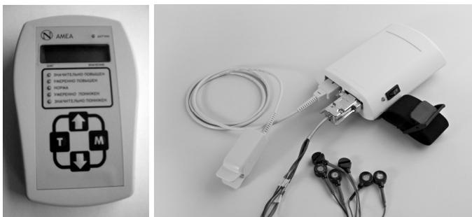
Рис. 3. Омега-метр для измерения электрической активности головного мозга; телеметрическая версия прибора нейроэнергокартограф.
